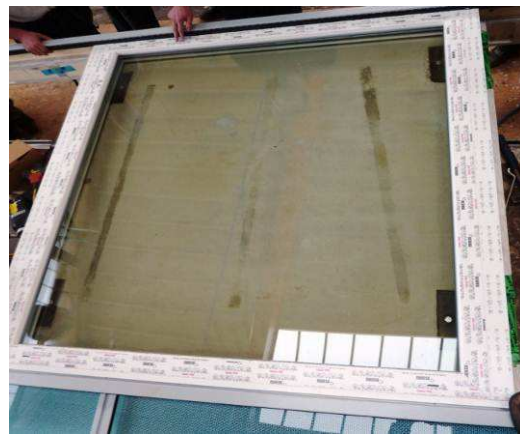
Im Werk fassadenintegriertes Modul WATER:solution & Fixerglasung
