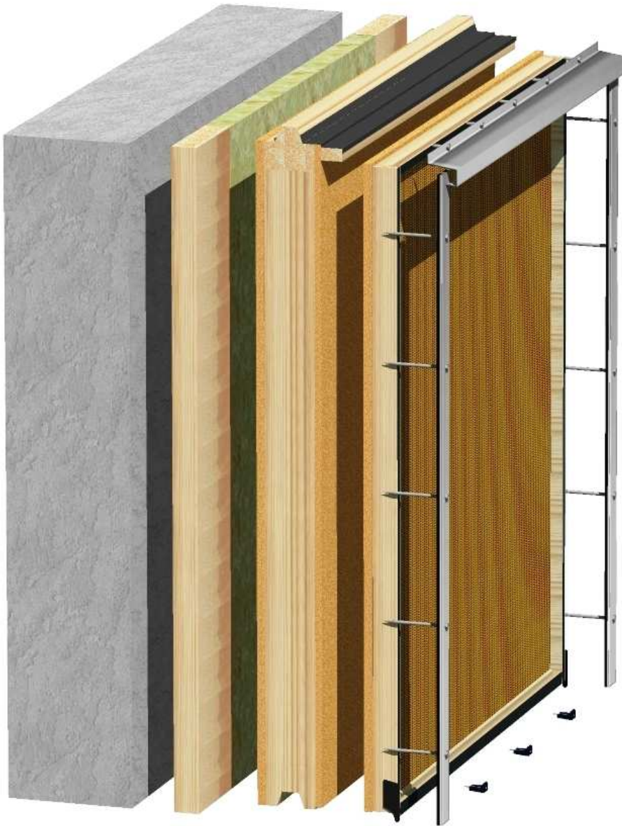
Unterkonstruktion mit Ausgleichsdämmung
